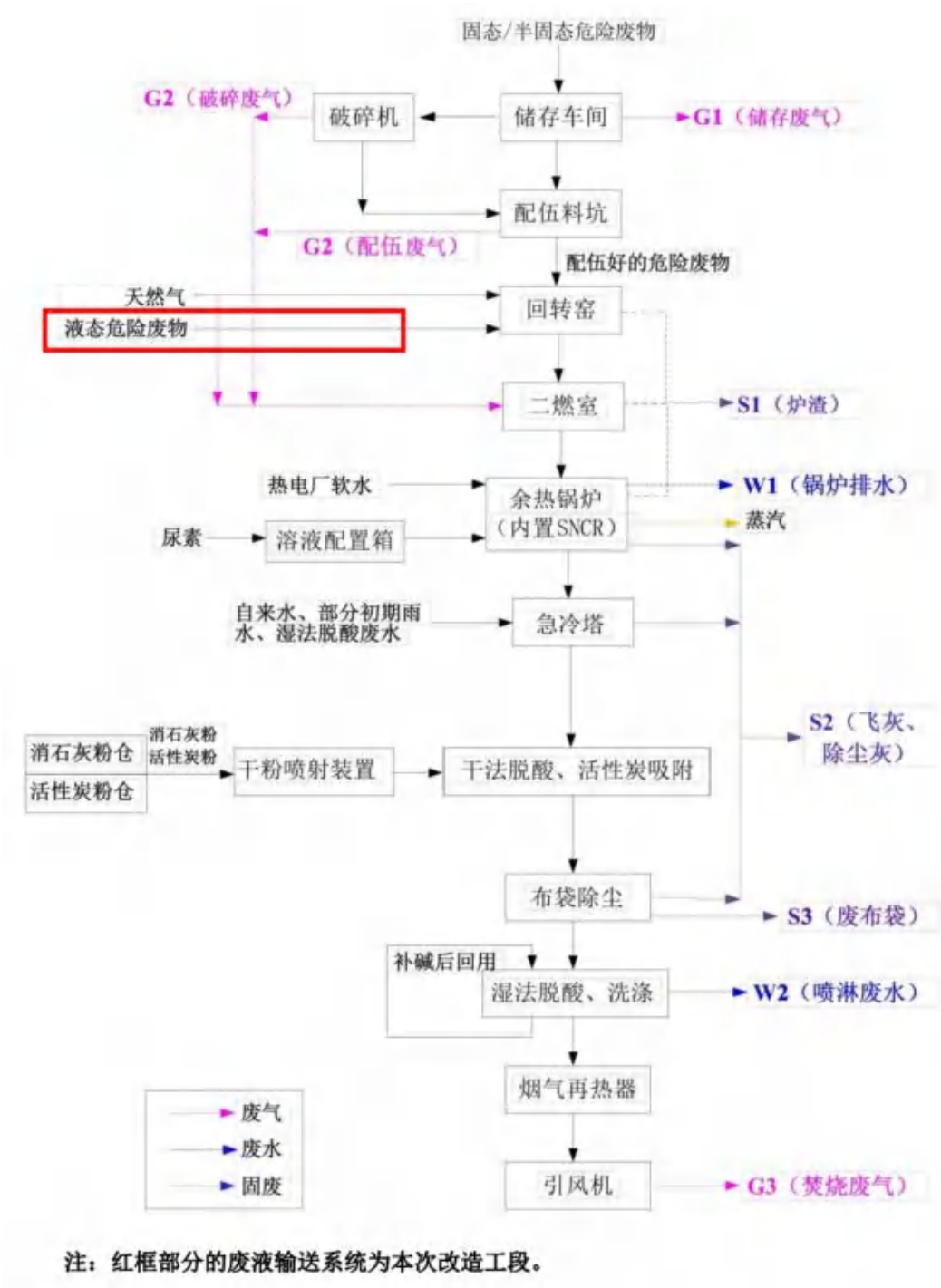
图3.5-2 技改后焚烧工艺流程示意图
