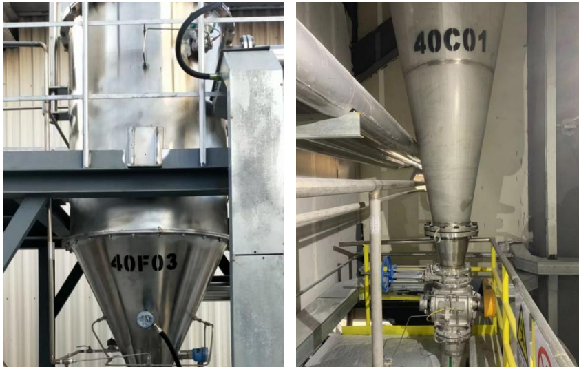
造粒车间的旋风除尘器
