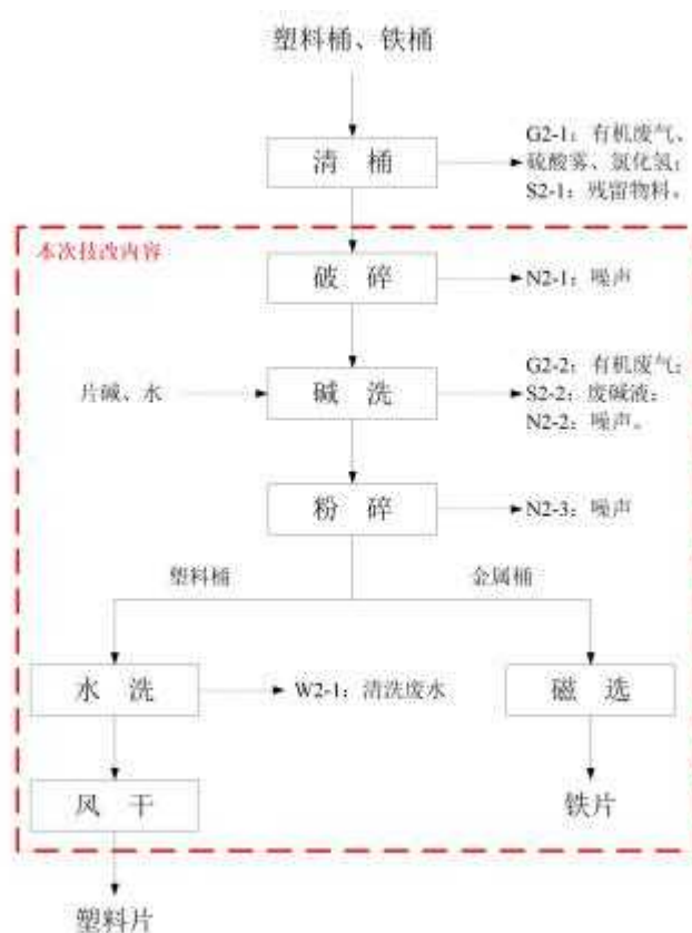
图3.3.2-1 小包装桶及破损包装桶清洗工艺流程及产污环节图
