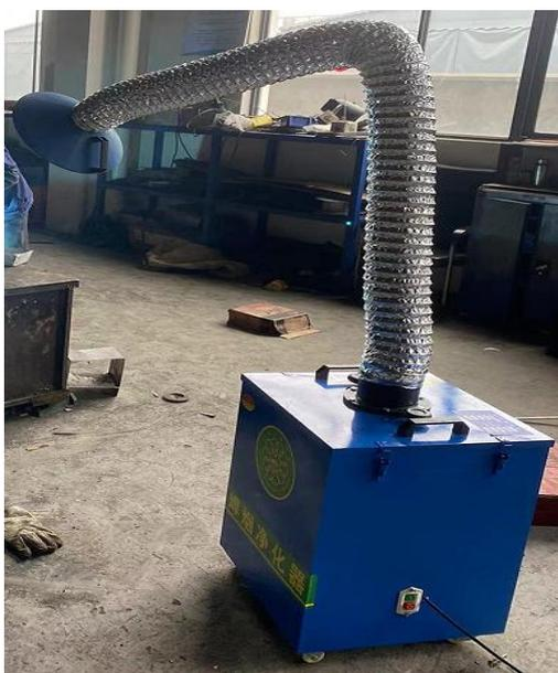
图 5-1 移动式焊烟净化器照片
