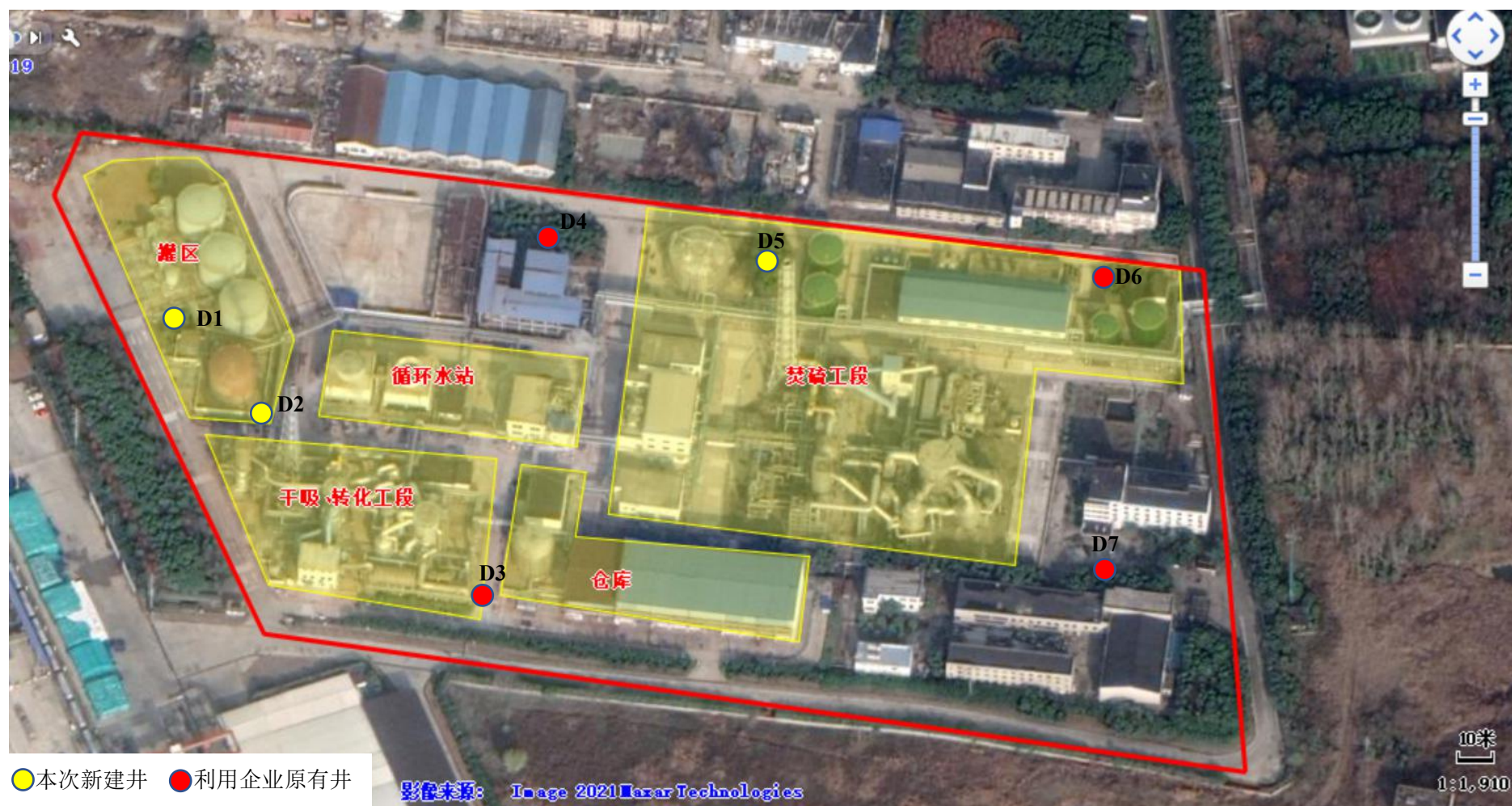
图 6.3-3 硫酸厂区地下水监测图（阴影为重点区域）
