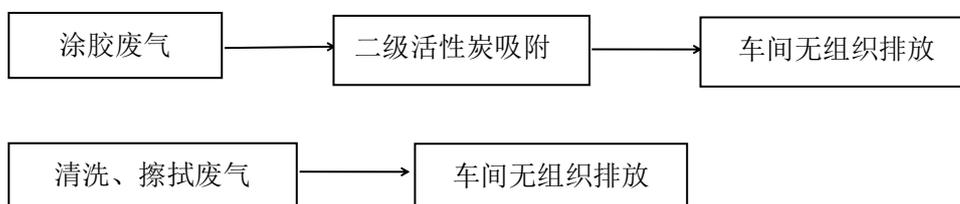
图5-8 涂胶废气、清洗废气、擦拭废气收集处理体系图
