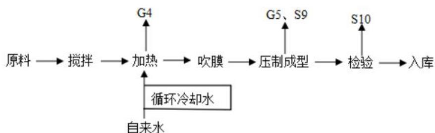
图3-3 塑料手套生产工艺流程及产污节点图
