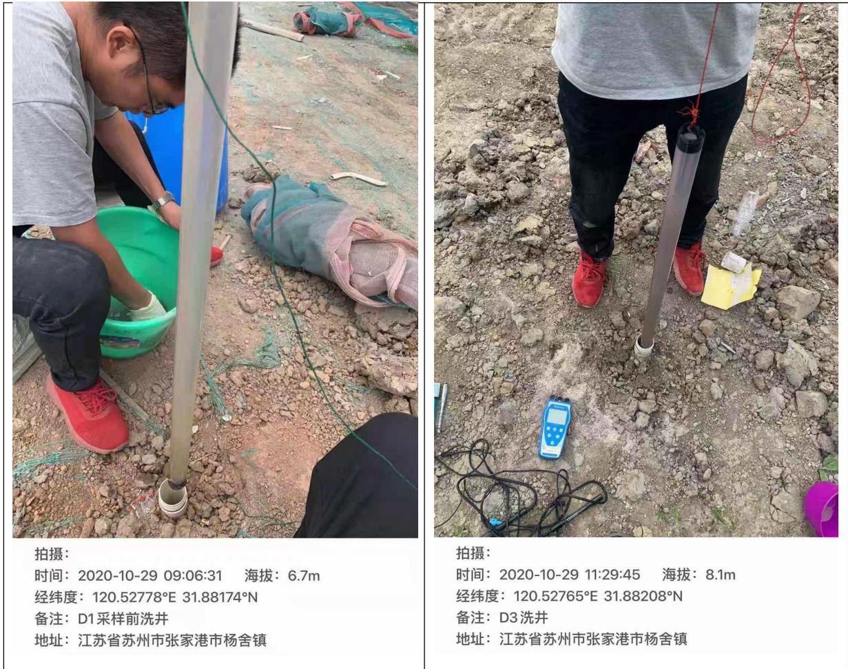
图4-7 地下水现场采样照片。
